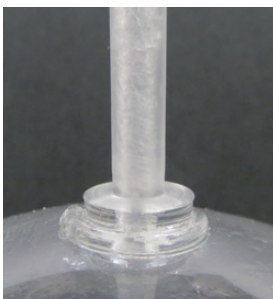
溶接加工 板を球状に加工し、先端にチューブ差し込み口を取付。
