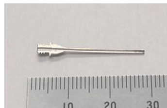
医療機器向けチタンの微細穴加工 弊社では穴の直径0.7mmに対して深さ30mmを実現。
