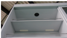
天井部 排気穴
